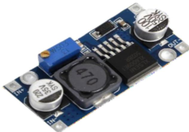
Figura 18 – Módulo elevador de tensão Step-up XL-6009.
